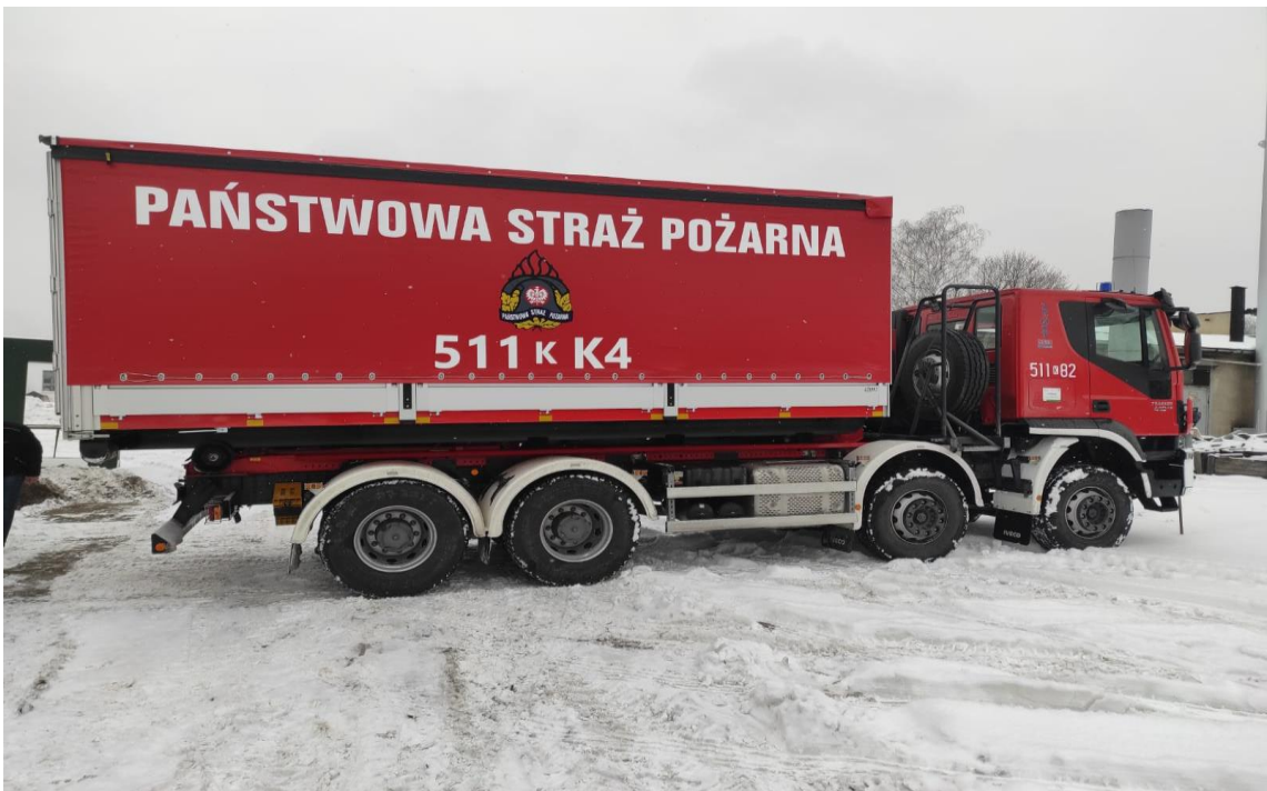
kontener transportowy – oplandeczony rok produkcji 2021 ładowność 9,5 tony przestrzeń ładunkowa 15 palet.
